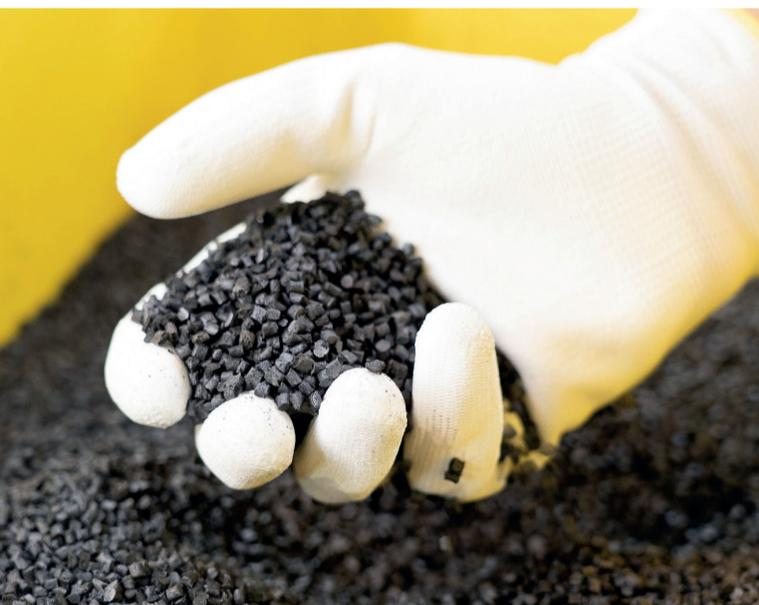
Kunststoff-Energieketten werden zu Granulat recycelt.
